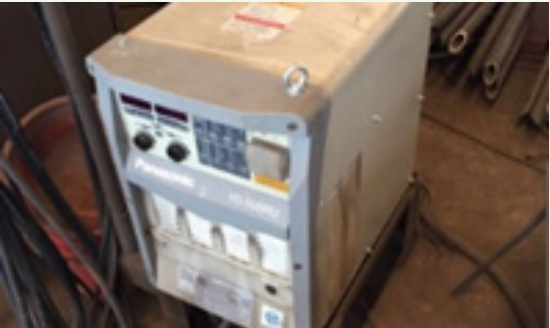
逆变气体保护焊机代替常规的可控硅焊机，淘汰高能耗设备
