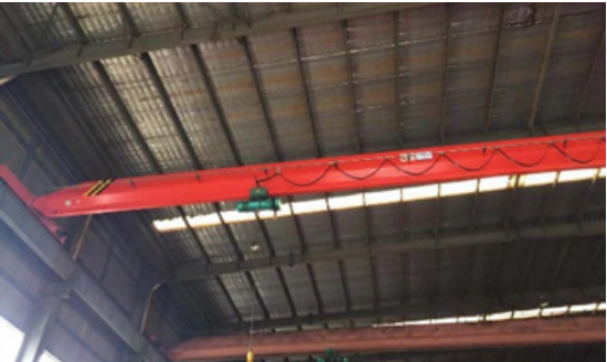
行车采用变频控制电机代替传统电机，降低能耗，启动更平稳
