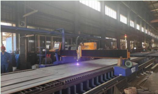
数控精细等离子切割机代替火焰切割机，提高生产效率，减少碳排放
