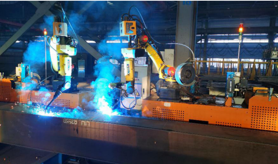
钢构件长焊缝机器人焊接工作站
